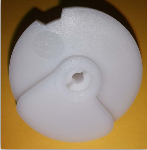
Camma traslatore bicchieri pre-modifica Codice a ricambio: 0V2545
